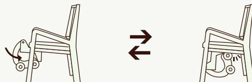
アームを一番奥まで押し込み、トレーニング部を支えながらストッパーを外します。そしてトレーニング部を回転させながら押し込み、カチッと音がすれば収納完了です。
